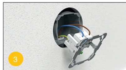
La prise est tirée un peu vers l'avant (les fils restent branchés)
