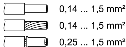
Bild 10: Klemmbarer Leiterquerschnitt Nebenstellen
