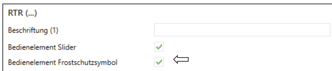
Abb. 160: Regler Frostschutzsymbol ein- oder ausblenden
