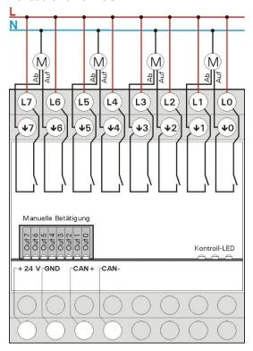
Die Baugruppe besteht aus einer Basis-Leiterplatte zur Aufnahme der Klemmen und Relais. Der Elektronikeinschub wird von vorne auf die Basis-Leiterplatte aufgesteckt und durch Schliessen des Deckels gesichert.
