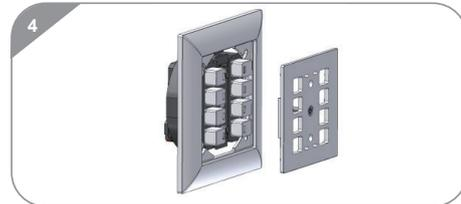
4 ■ Enlever le couvercle de protection, monter le cadre de recouvrement et visser la plaque de recouvrement.
