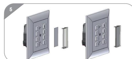
■ Der ggf. bedruckte Beschriftungsträger in das Beschriftungsfenster einlegen und einsetzen.
