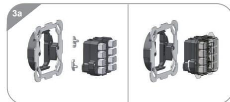
3a ■ Montage avec compensation: au besoin raccorder le set de la compensation encastrée (de 1.5mm d'épaisseur), puis monter le poussoir.
