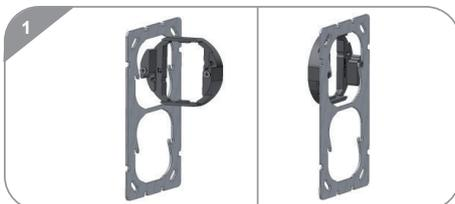
1 ■ **Uniquement pour le montage en combinaison:** montage de la bague de fixation au cadre de fixation
