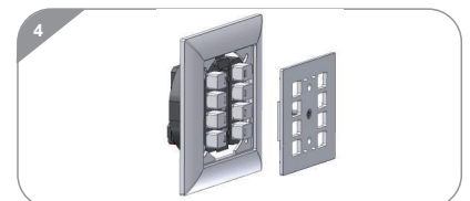
■ Enlever le couvercle de protection, monter le cadre de recouvrement et visser la plaque de recouvrement.
