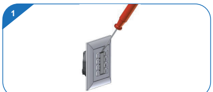
■ Zur Gerätedemontage zunächst das Beschriftungsfenster mit einem geeigneten Werkzeug entfernen, danach kann der Taster in umgekehrter Reihenfolge wie bei der Montage demontiert werden.
