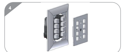
■ Schutzdeckel entfernen, Abdeckrahmen aufsetzen und mit Abdeckplatte verschrauben.
