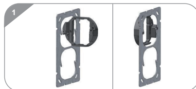
■ Uniquement pour le montage en combinaison: montage de la bague de fixation au cadre de fixation
