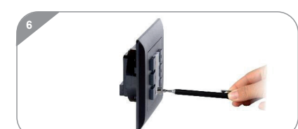
■ Le bouton-poussoir installé peut être mis en mode de programmation sans aucun démontage avec le capteur magnétique.
