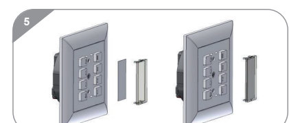
■ Der ggf. bedruckte Beschriftungsträger in das Beschriftungsfenster einlegen und einsetzen.
