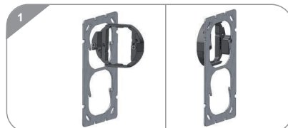
■ Nur beim Einbau in die Kombination: Montage des Befestigungsringes am Befestigungsrahmen.
